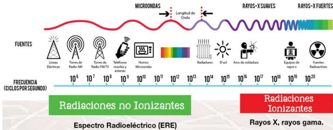
Figura 5 Servicios y frecuencias asociadas con el espectro electromagnético, fuente: (ANE,2018).
